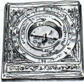
C ompendium astronomique en cuivre doré et argenté (instrument à usages multiples). Il fut probablement exécuté par Schissler d'Augsbourg vers 1600.
